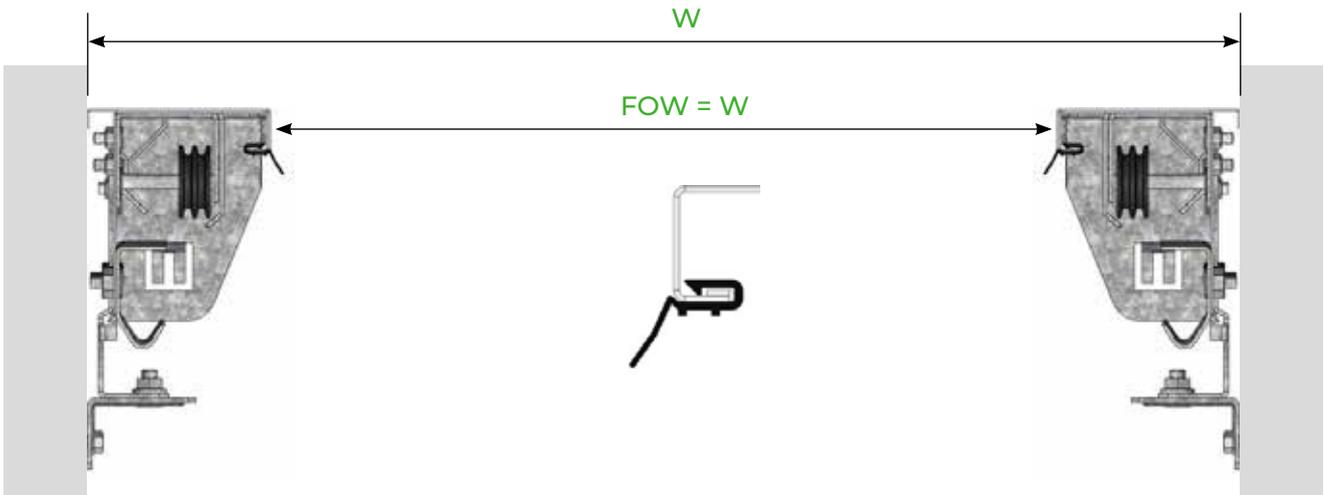
2. OPTION – mit senkrechten Verkleidungsblechen „L“; niedrige Dichtung. Die Montage erfolgt bündig mit der Außenfassade. 120mm lange „L“ Verkleidungsbleche können beschädigte Außenkanten der Fassade überdecken.
